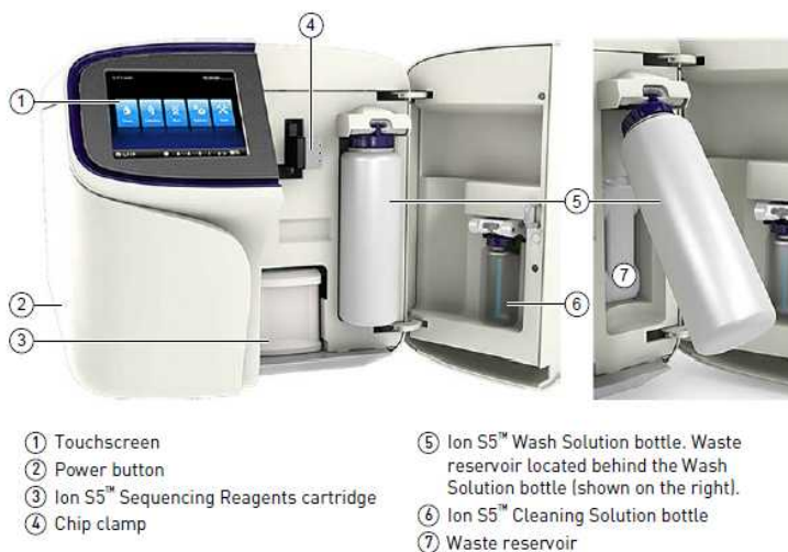
Slika 16. Položaji komponent sistema Ion S5 in Ion GeneStudio S5
