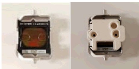
Slika 8. Čip Ion torrent Chip v nosilcu rotorja
